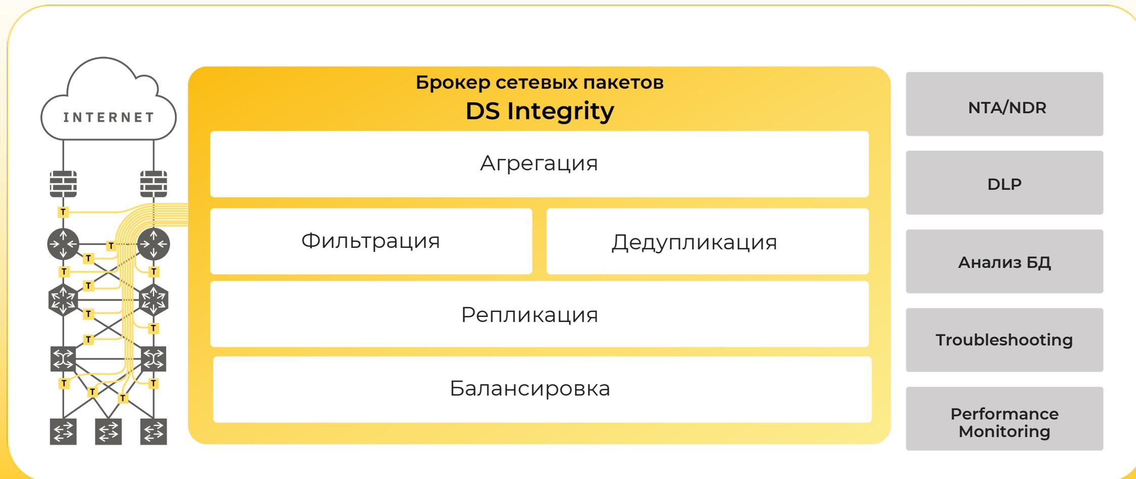
**Брокер сетевых пакетов получает трафик, подготавливает и передает копии на несколько систем**
